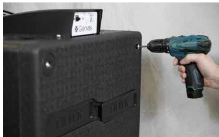
1. Fjern skruer fra frontpladen for adgang til interne dele.
